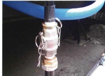
給水管が工具なしで着脱可
